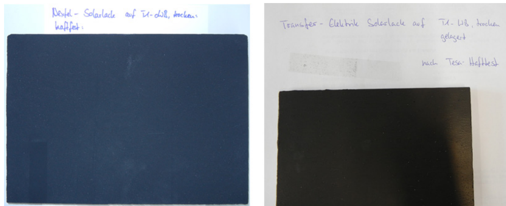
Abbildung 84: Nichtselektiv lackierte UHPC-Platten
