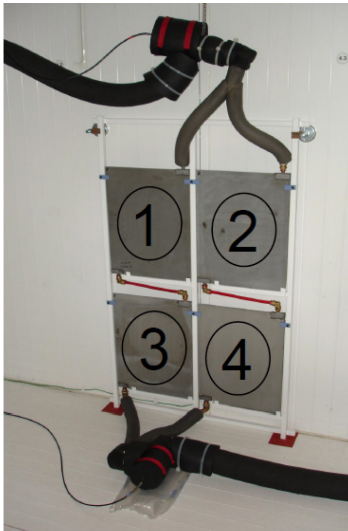
Abbildung 104: Versuchsaufbau zur Leistungsmessung der vier TABSOLAR-Elemente
