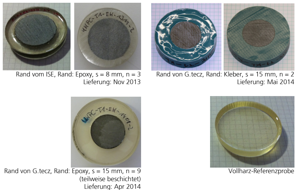
Abbildung 12: In Epoxidharz bzw. Klebstoff eingegossene UHPC und Referenz aus Vollharz
