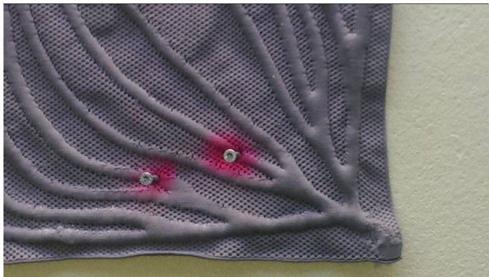
Abbildung 61: Beschädigte Stellen an den FracTherm®-Kanälen, Austritt von Granulat (durch rote Farbe und Schrauben markiert)
