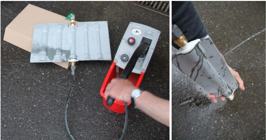
Abbildung 67: Erfolgreiche Druckbeständigkeitsprüfungen am mittleren Sammelkanal aufgrund von Lunkern
