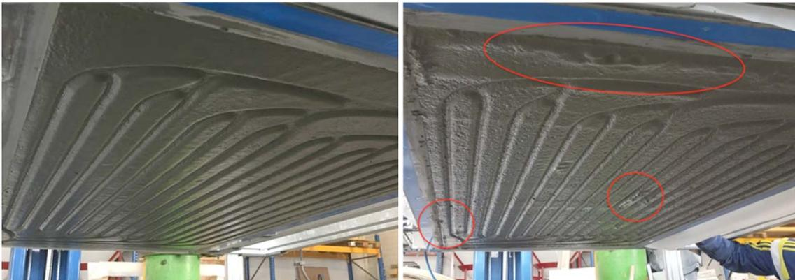
Abbildung 136: Einfluss der Fließgrenze: kein Abtropfen des Frischbetons nach dem Wenden (links), abtropfender Frischbeton infolge reduzierter Fließgrenze (rechts)
