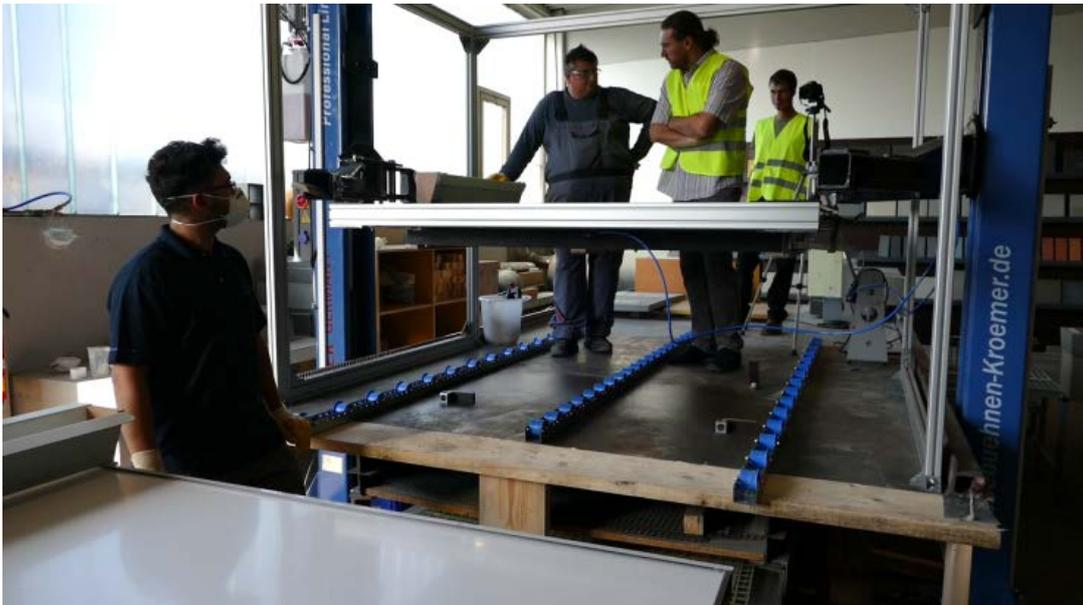
Abbildung 139: Werkzeughälften vorbereitet zum Betonieren
