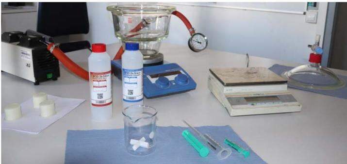
Abbildung 72: Herstellung Manteldichtung mit 2K-Silikon und Exsikkator
