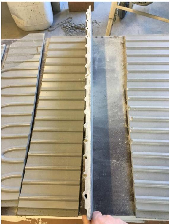
Abbildung 138: TABSOLAR®-Element mit nicht durchströmbaren Kanalstrukturen, trotz geeigneter Frischbetonkonsistenz
