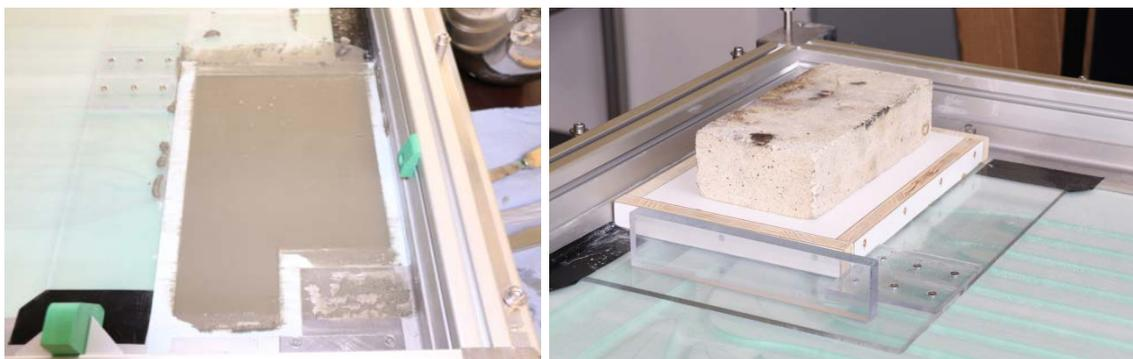
Abbildung 118: Versuchsfläche für Tiefziehversuche am Fraunhofer ISE im Bereich der Hydraulikanschlussabformung (links), aushärtendes Pre-mix-Element (rechts)
