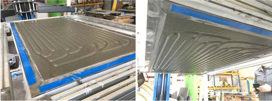
Abbildung 135: Gefüllte Werkzeughälfte nach dem Tiefziehen des Frischbetons (links), Werkzeughälfte nach dem Wenden – kein Abtropfen des Frischbetons erkennbar (rechts)
