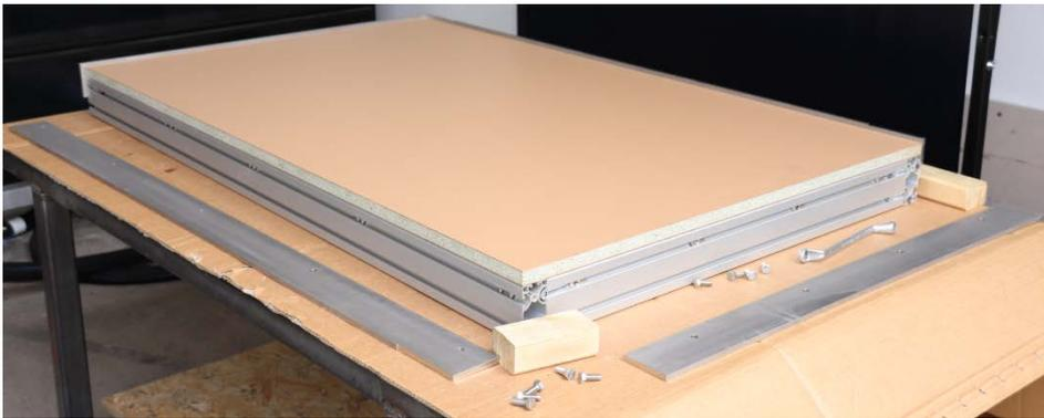
Abbildung 114: Schalung der ebenen Platte
