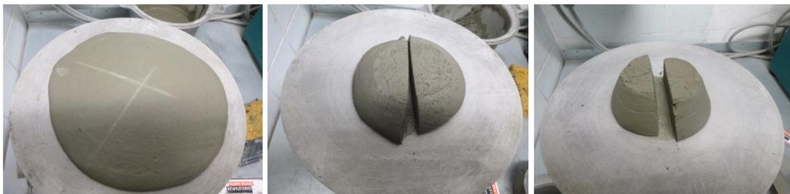
Abbildung 126: Frischbeton mit geringer (links), mittlerer (Mitte) und ausgeprägter (rechts) Fließgrenze
