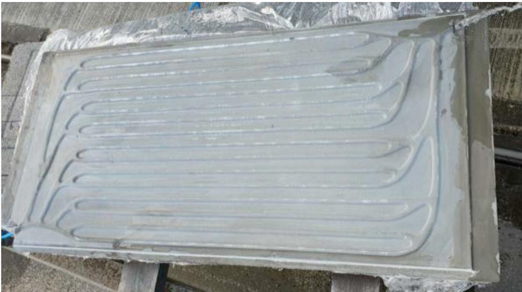
Abbildung 147: Durchströmbares TABSOLAR®-Element – hergestellt bei Spürgin unter Zuhilfenahme des angepassten Verfahrens; der offene Ablauf ist rechts oben zu erkennen
