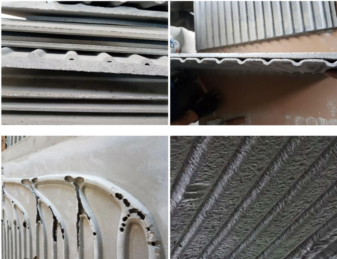
Abbildung 137: Typische Fehlerbilder bei der Herstellung von TABSOLAR®-Elementen: nicht ausgeprägte Kanäle (links oben), schlechte Verbindung der Hälften (rechts oben), offene Kanäle (links unten), schlechtes Flussverhalten (rechts unten)
