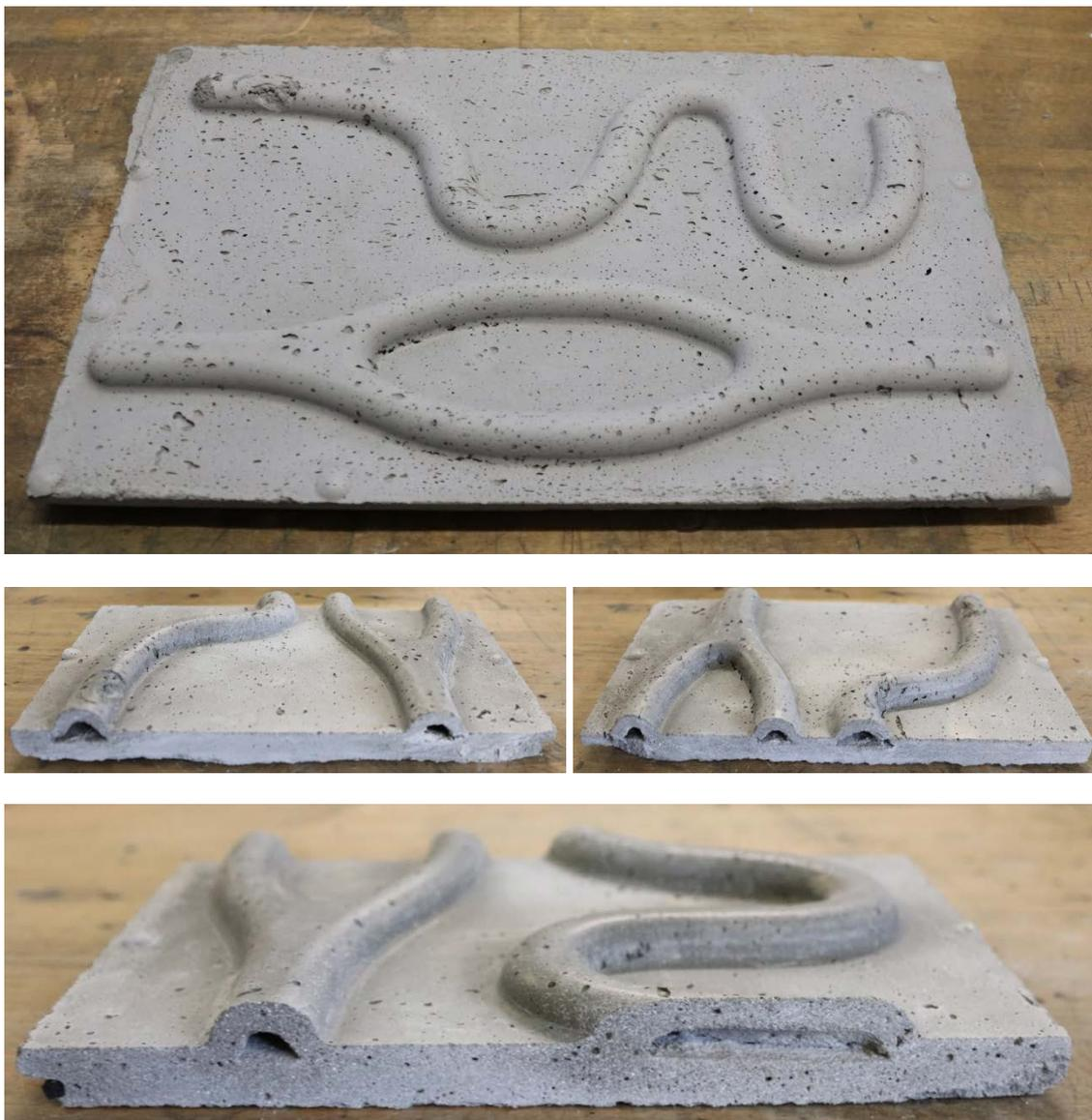
Abbildung 149: Mit Hilfe eines zweiten modifizierten Membran-Vakuumtiefziehverfahrens hergestelltes kleines Musterelement (oben) mit Querschnitten (Mitte und unten)
