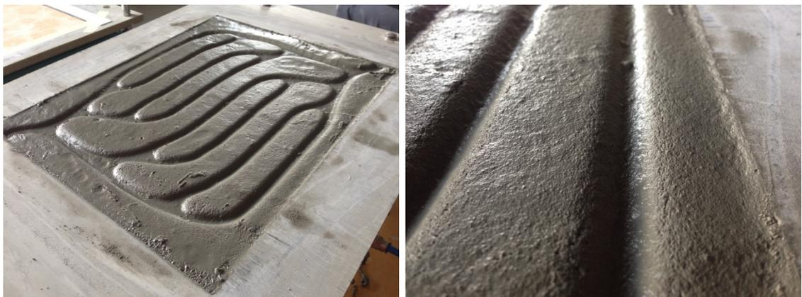
Abbildung 54: Tiefgezogene Kanalstrukturen unter Verwendung der Spürgin adaptierten Mischungsrezeptur
