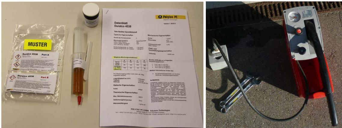
Abbildung 65: Flexibler Hochtemperaturklebstoff Duralco 4538 (links), Erfolgreiche Druckbeständigkeitsprüfung des 3D-gedruckten Hydraulikanschlusses (rechts)
