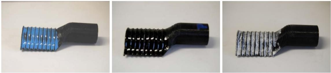
Abbildung 52: Hydraulikanschlüsse mit unterschiedlichen Beschichtungen der Firma SmoothOn: Silikon (Smooth Sil 950, links), Polyurethan (PMC770, Mitte), Epoxidharz (Plasti Paste II, rechts)
