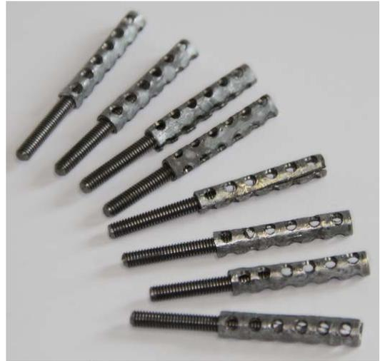
Abbildung 71: Siebdübel mit Gewindestange: Zeichnung (links), händisch hergestellte Exemplare (rechts)
