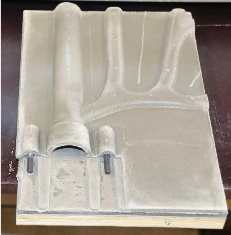
Abbildung 119: Ausgeschaltetes durchströmbares Element aus Pre-mix mit Sammelkanal und Hydraulikanschlussmöglichkeit
