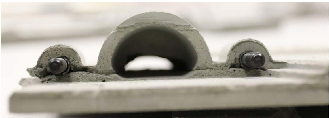
Abbildung 120: Hydraulikanschlussmöglichkeit über Anschlusskonus und eingebettete Siebdübel
