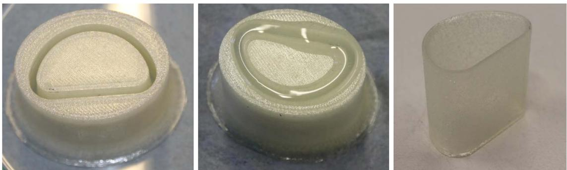
Abbildung 73: Aus einem wasserlöslichen Filament gedruckte Gießform (links), Gießform gefüllt mit 2K-Silikon (Mitte), hergestellte Manteldichtung nach Auflösung der Gießform im Wasserbad (rechts)
