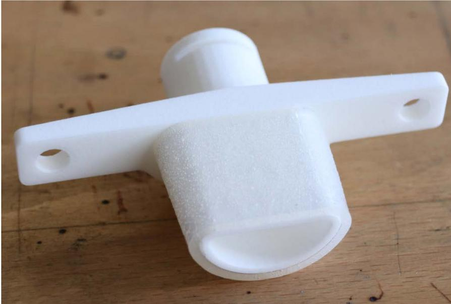
Abbildung 74: 3D-gedruckter Hydraulikanschluss aus Nylon mit Manteldichtung aus 2K-Silikon
