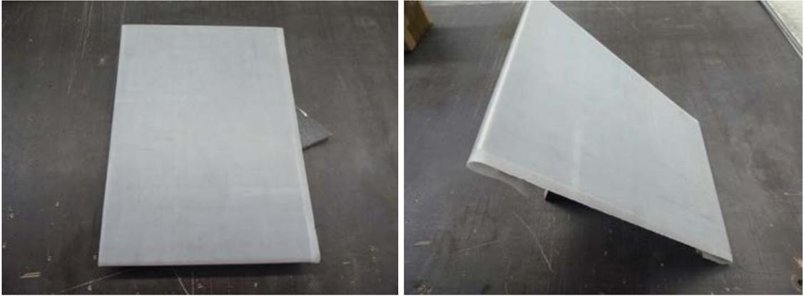
Abbildung 127: Versuchsaufbau: Versuchsbrett liegend zur Bestimmung des Setzfließmaßes (links) und aufgestellt unter 45° zur Bestimmung der Fließeigenschaften (rechts)
