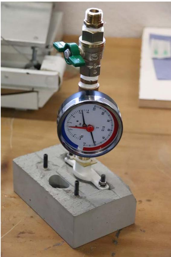
Abbildung 124: Dichtigkeitsprüfung des Hydraulikanschlusses im Pre-mix-Block
