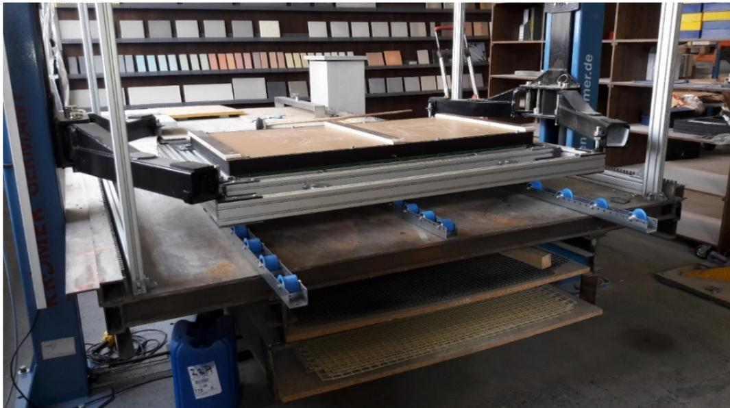
Abbildung 106: Realisierung der Wendeeinheit
