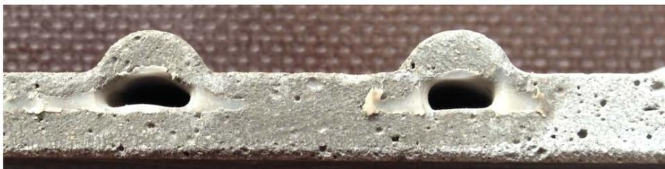
Abbildung 46: Überfüllung der Zwickelstellen – Verkleinerung des Querschnitts
