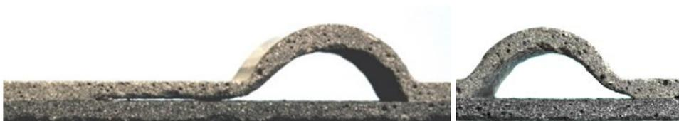
Abbildung 85: Spalt zwischen den Schichten (links) und längliche Zwickelform (rechts)
