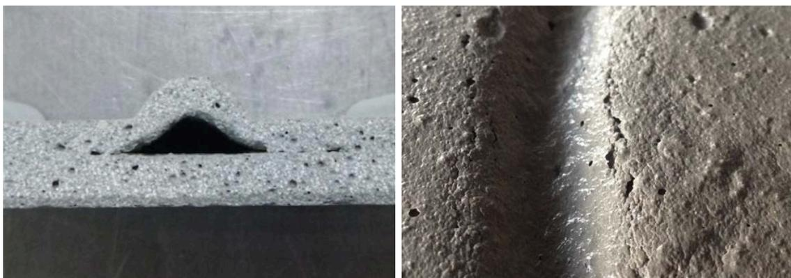
Abbildung 125: Kanalstruktur mit inhomogener Querschnittsdicke der Kanalwandung (links), Rissbildung im Frischbeton beim Tiefziehen aufgrund einer erhöhten Fließgrenze (rechts)
