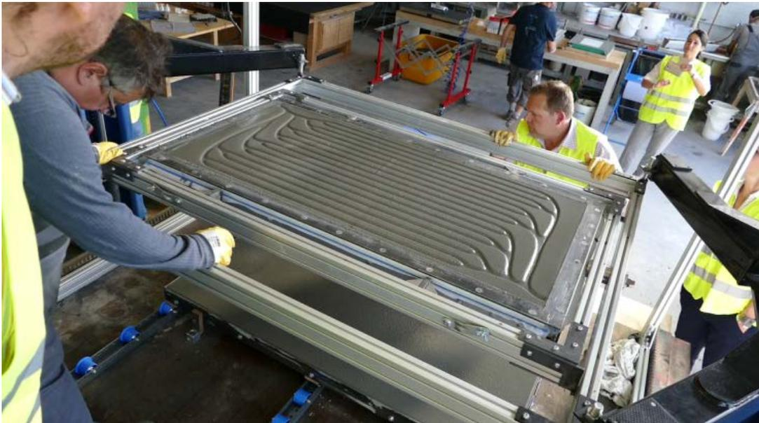
Abbildung 140: Betonierte Hälften nach dem Tiefziehen vor dem Einwenden und Zusammenfügen
