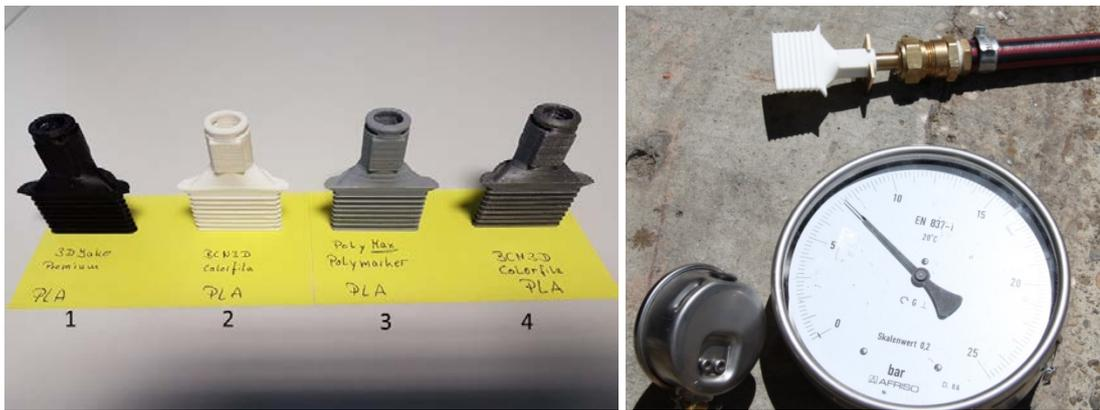
Abbildung 58: Hydraulikanschlüsse aus vier unterschiedlichen 3D-Druck-Materialien für Druckbeständigkeitsprüfungen (links), erfolgreiche Druckbeständigkeitsprüfung (11 bar Berstdruck) an einem von vier Hydraulikanschlüssen (rechts)
