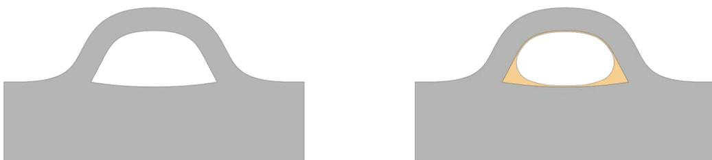
Abbildung 44: Kanalstruktur ohne und mit Auskleidung der Oberfläche und Zwickelstellen
