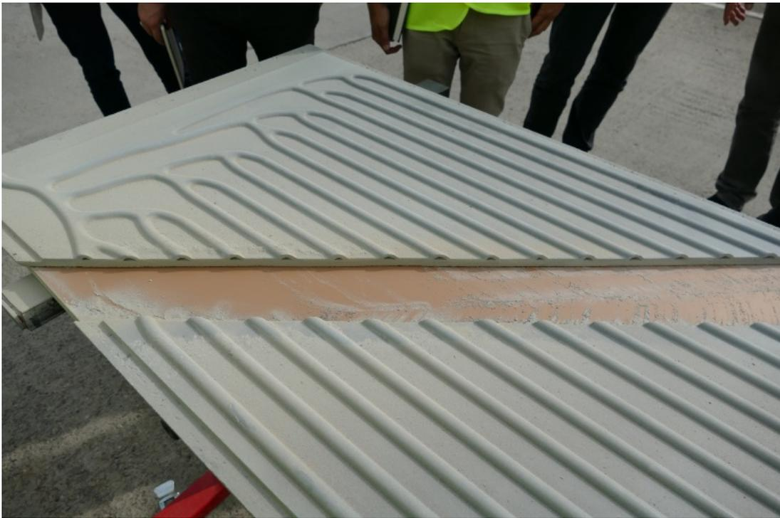
Abbildung 143: Aufgetrenntes TABSOLAR®-Element
