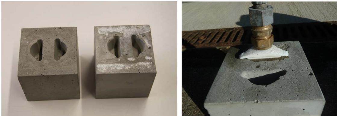
Abbildung 64: Zwei UHPC-Würfel mit je zwei abgeformten Hydraulikanschlussformen (links), UHPC-Würfel mit eingeklebtem Hydraulikanschluss (rechts)
