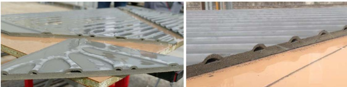
Abbildung 144: Aufgetrenntes TABSOLAR®-Element: Detailansicht der Kanäle
