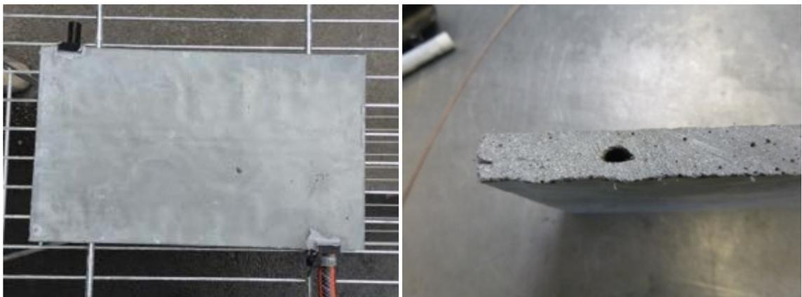
Abbildung 145: Beispiel eines kleinen Musterelementen (links) mit durchströmbarem Kanalquerschnitt (rechts)
