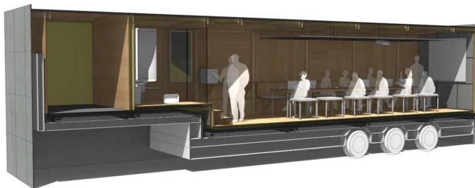
Abbildung 186: Schnittmodell eines mobilen Demonstrationsgebäudes (LKW-Auflieger) als Ausstellungsraum (oben) bzw. als Besprechungsraum (unten)
