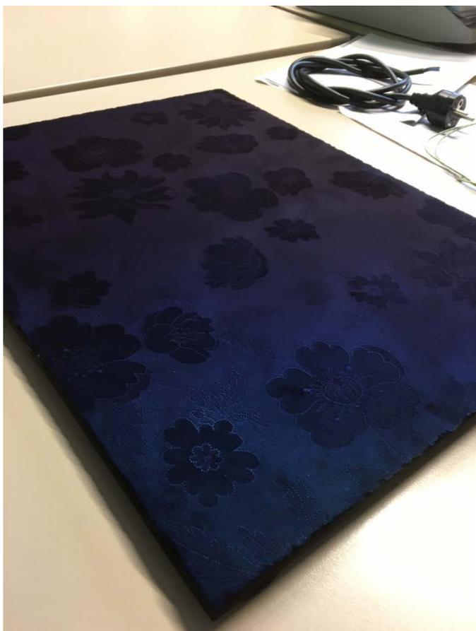
Abbildung 158: Variante von TABSOLAR® *Design* mit spektralselektiver Beschichtung, jedoch ohne Witterungsschutz
