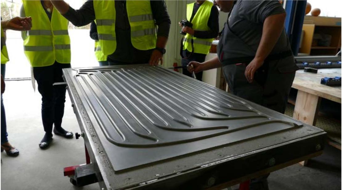
Abbildung 141: Ausgeschaltetes TABSOLAR®-Element: Kanalseite
